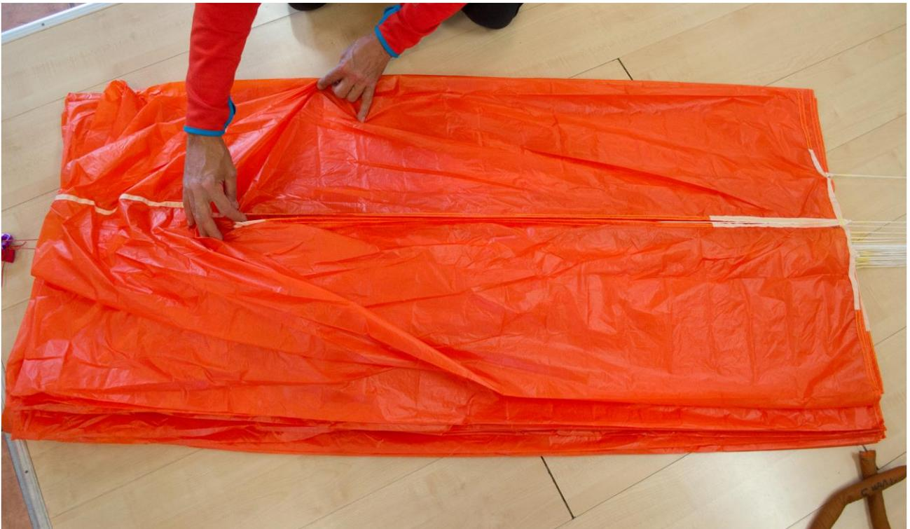
Die Bahn 2 wird dann mit Packgewichten oben und unten fixiert. Danach schlägt man alle Bahnen der rechten Seite nach links.
