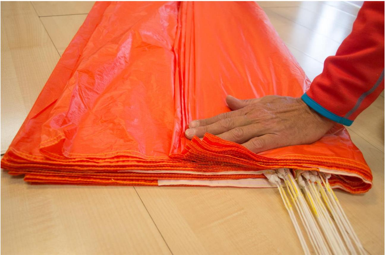
Zwei Drittel der linken Seite werden unter den Schirm geschlagen. Dies geht am besten mit einem Helfer am oberen Ende der Kappe, der die Bewegung synchron mitmacht.
