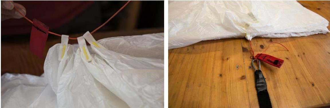
Am unteren Ende des Packtisches wird der Fanggurt fixiert und das Rettungsgerät gespannt. Die Fangleinen werden auf geraden Verlauf überprüft. Dazu nimmt man das Fangleinenbündel links und rechts der Mittelleine, sowie die zwei der Mittelleine nächsten Fangleinen auf und kontrolliert deren Verlauf vom Hauptgurt bis zur Kappe. Achtung auf Verdrehungen der Leinen, die unbedingt entwirrt werden müssen!
