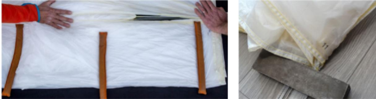
Falten Sie nun alle über dem Packgewicht gelagerten Bahnen auf die rechte Seite. Beim ALFAcross 100 befindet sich Bahn 11 unten, beim ALFAcross 120 und ALFAcross 140 Bahn 13 und beim ALFAcross 220 Bahn 15.
