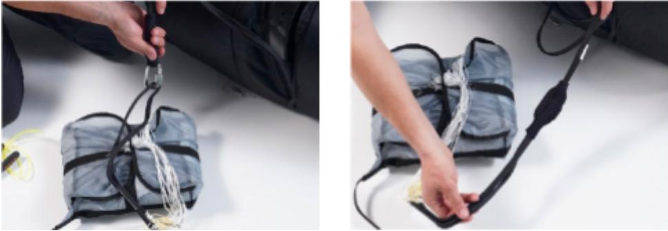
Alternativ kann Rettungsschirmtragegurt auch mit der Gurtzeug-Verbindungsleine verschlauft werden, wenn mindestens eine von beiden eine Schlaufe hat, die so groß ist, dass der Rettungsschirm durchgesteckt werden kann.
